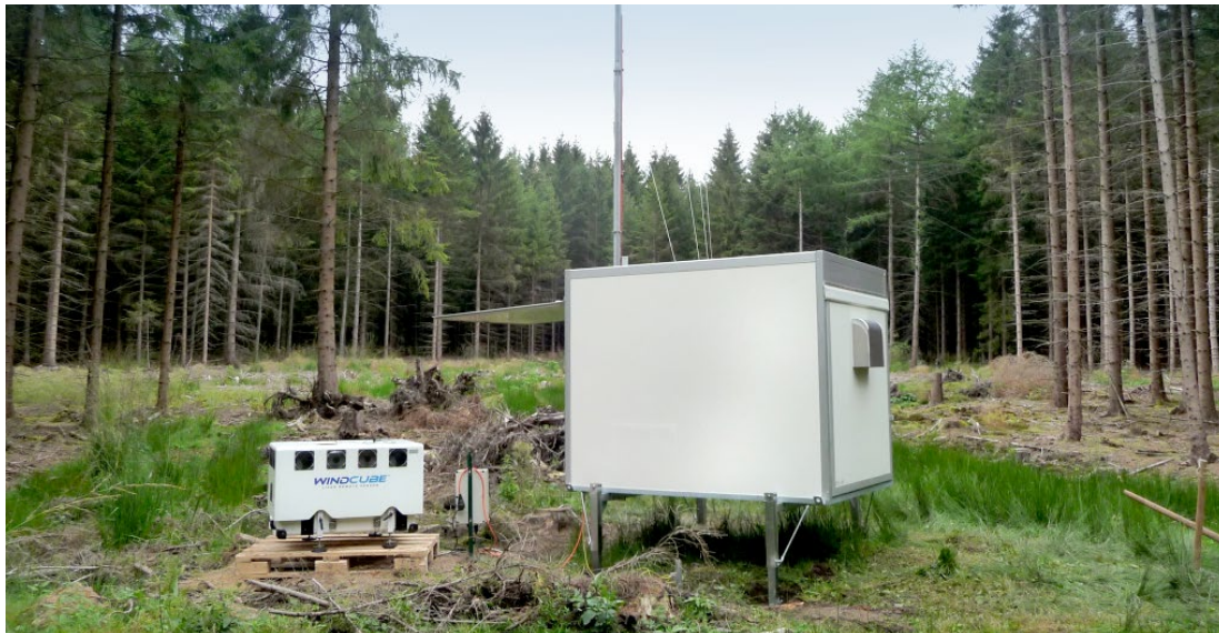
Bild 6: Lidar- Gerät zur Windmessung mit Lasertechnologie
