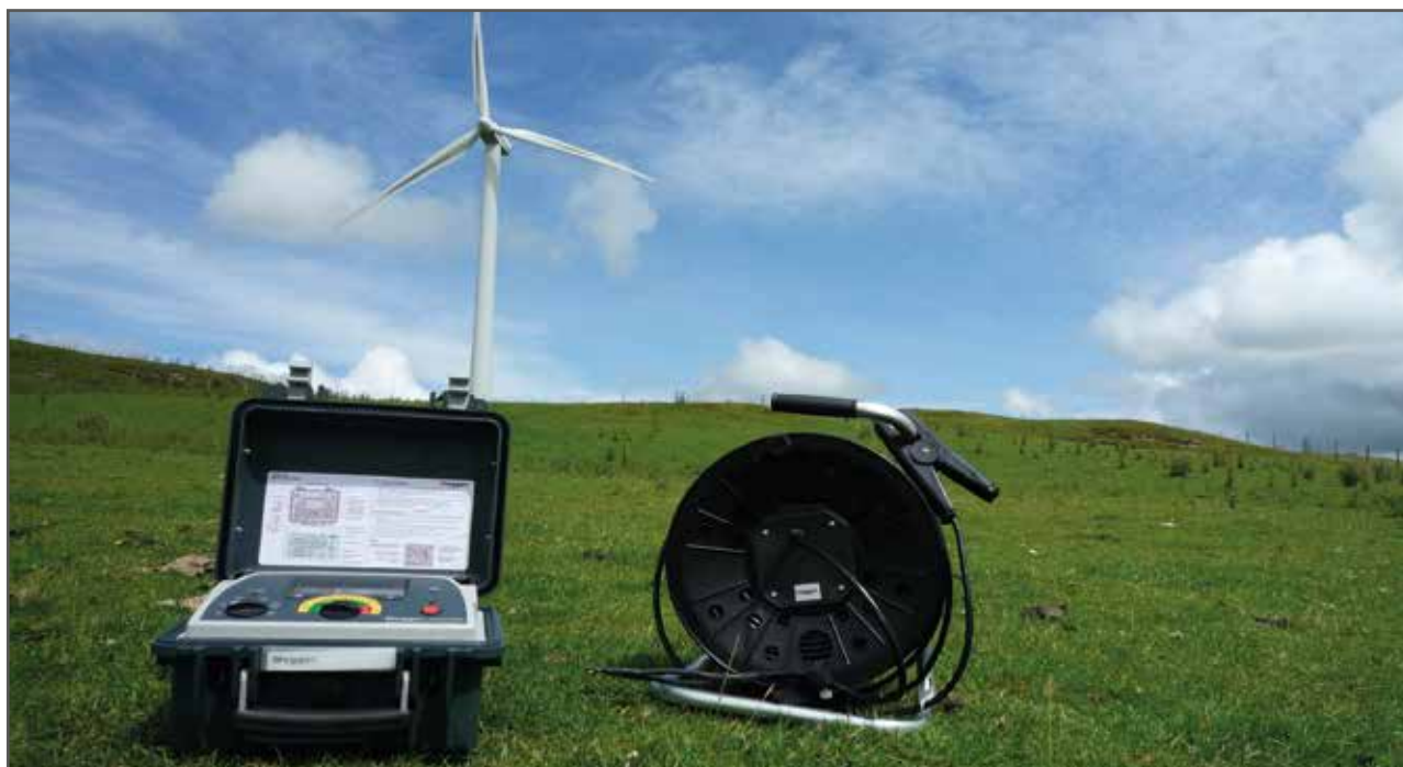
DLRO10HDX mit KC- Messleitung: Max. 100 Meter sind ideal. Noch längere Kabel machen die Trommel zu schwer.
