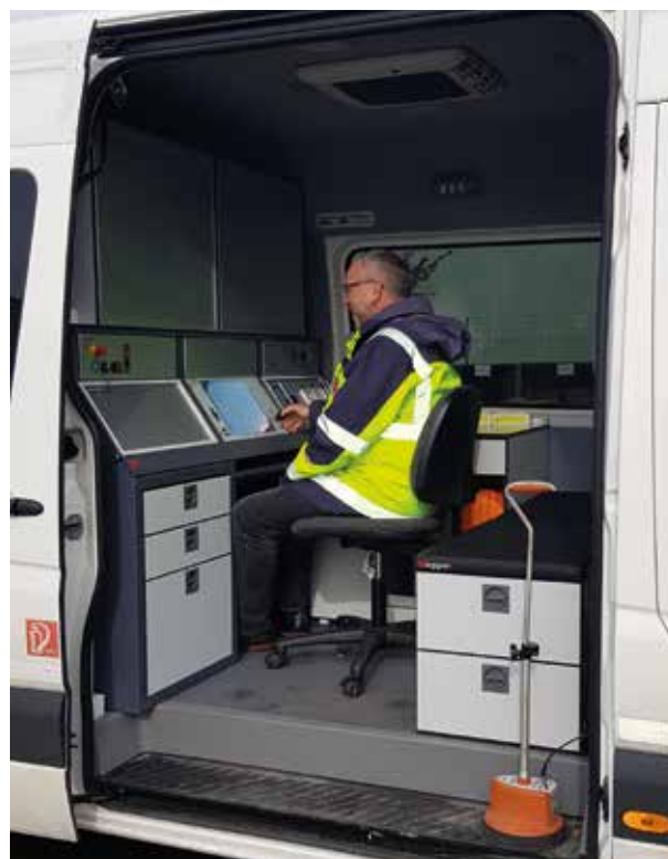
Bild 5: Der R30 von Megger bietet einen 50 kV Stoßgenerator und eine 110 kV-Hochspannungsprüfanlage
