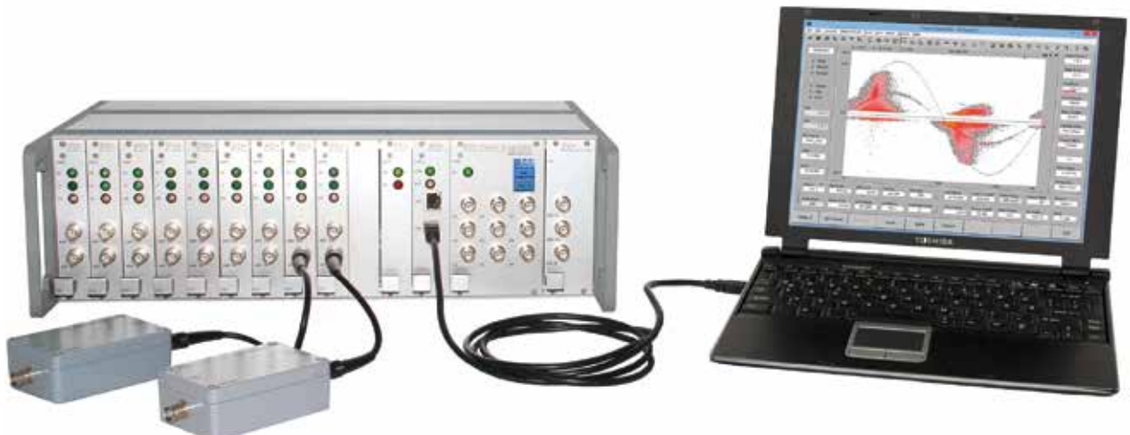
Bild 1: Das ICMsystem ist ein universelles Ortungs- und Analysegerät für Service- und Abnahmeprüfungen zum Aufspüren von Teilentladungen an Leistungstransformatoren und an weiteren Komponenten der Netzinfrastruktur.
