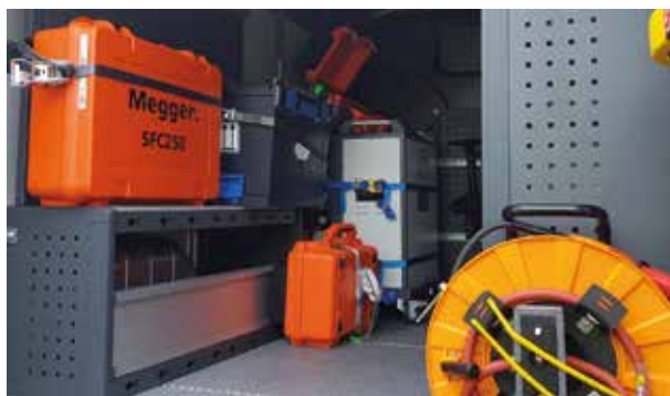
Bild 3: Die flexibel installierte Messtechnik im Ford
