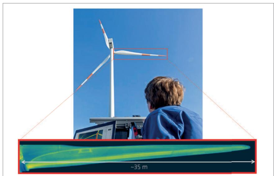
Abb. 1: Visualisierung der inneren Struktur basierend auf der thermischen Inspektion rotierender Rotorblätter. Quelle: BAM
